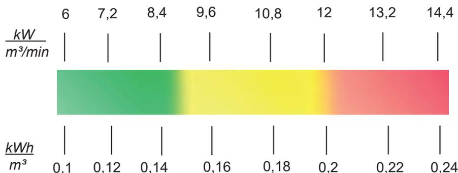
Un tipico assorbimento di potenza specifico di un compressore ad iniezione d'olio può essere il seguente.
